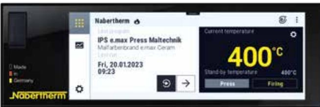
A seconda del modello di forno, la temperatura di standby può essere selezionata per il processo di cottura o pressatura e anche regolata individualmente.
