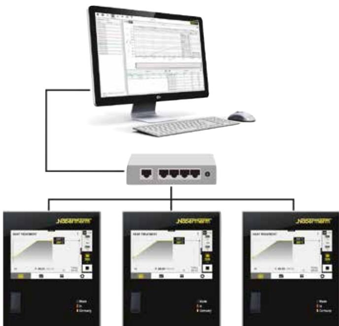
Esempio di configurazione con 3 forni
