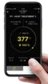
L'avanzamento del processo può essere monitorato con un dispositivo mobile (IOS o Android) utilizzando l'app gratuita MyNabertherm (connessione del forno tramite Wi-Fi).
